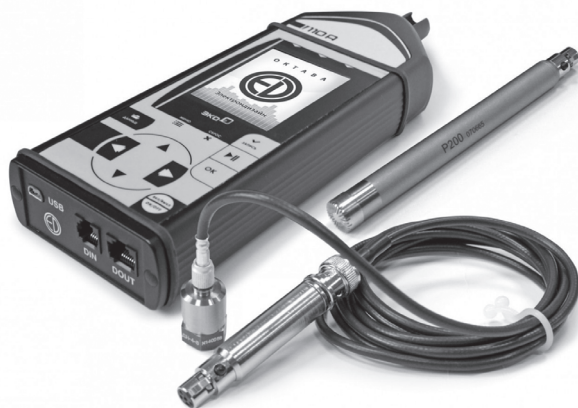
Рис. 1.2. Шумомер, вибромер и анализатор спектра «ОКТАВА-110А-ЭКО»
