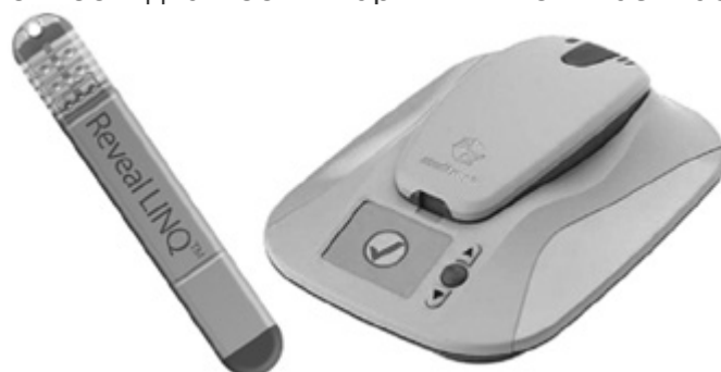
Рис. 1.9. Имплантируемый аппарат Reveal LINQ ICM с петлевым типом записи электрокардиограммы и MyCareLink Monitor, посылающий информацию врачу Наряду с выявлением причин обмороков в настоящее время изучаются возможность и экономическая эффективность использования аппаратов длительной регистрации ЭКГ при риске ФП (ХРЕСТ), криптогенных инсультах (CRYPTONITE, CRISTAL AF), для градации риска после ИМ.
