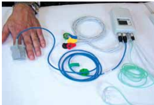
Рис. 10. Комбинированный монитор ЭКГ и дыхания (фирма ИНКАРТ, Россия). Наряду с 12 отведениями ЭКГ к прибору подключаются датчики дыхания (катетер) и пульсоксиметрии. Для уменьшения числа устанавливаемых на обследуемого датчиков некоторые каналы комбинируются: храп регистрируется с помощью датчика дыхания, грудная и брюшная пневмограммы — реографическим методом с ЭКГ-электродов, с которых также записываются движения и положение тела пациента
