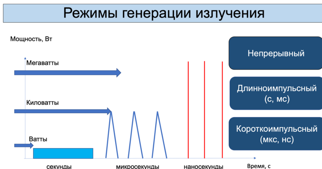
Рисунок 15 – Схематическое представление режимов генерации лазерного излучения
