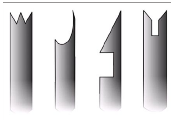
Рис. 11. Различные типы игл с режущими краями (указаны канюли игл, мандрен у всех одинаков).
