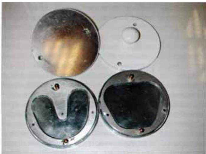
Рис. 4.2. Штампы и контршампы для изготовления индивидуальных ложек.
