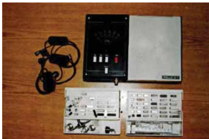
Рис. 5.6. Аппарат для определения центрального соотношения челюстей функционально-физиологическим методом.
