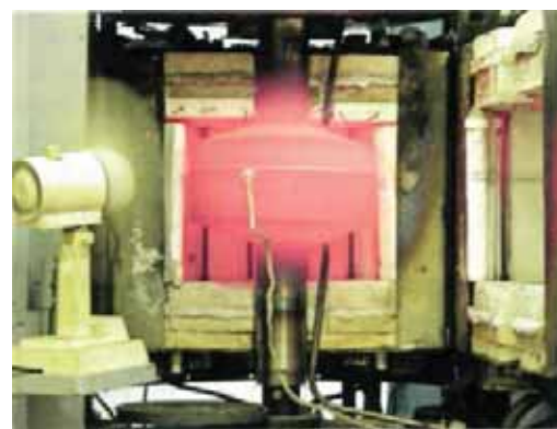
Рис. 10.11. Аппарат для сверхпластичной штамповки титана.
