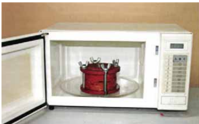
Рис. 15.1. Диэлектрическая кювета в микроволновой установке «Дента».
