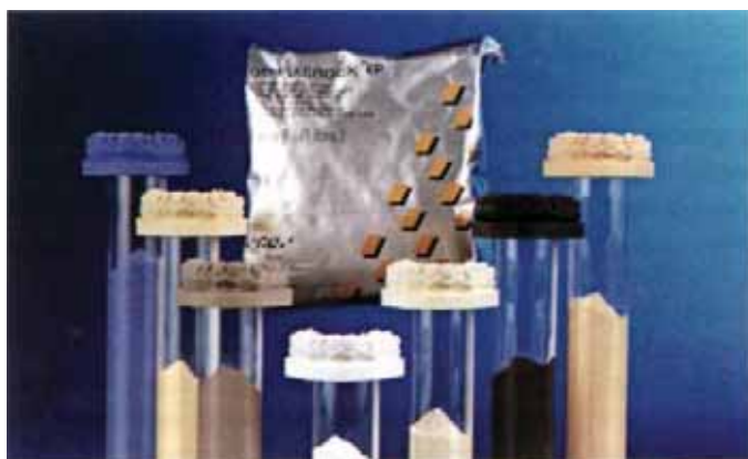
Рис. 16.2. Модели, изготовленные из различных видов гипсов.
