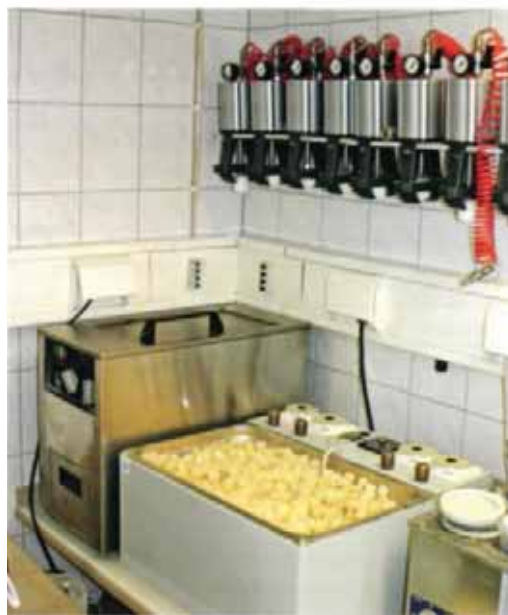
Рис. 15.5. Аппарат для полимеризации пластмасс холодной полимеризации.
