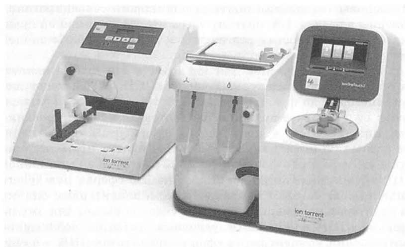
Рис. 3.8. Система OneTouch 2 (Life Technologies Thermo Fisher Scientific) для проведения эмульсионной ПЦР. Слева – модуль ES, служащий для обогащения фракции сработавших сфер, справа – OneTouch 2 для проведения эмульсионной ПЦР
