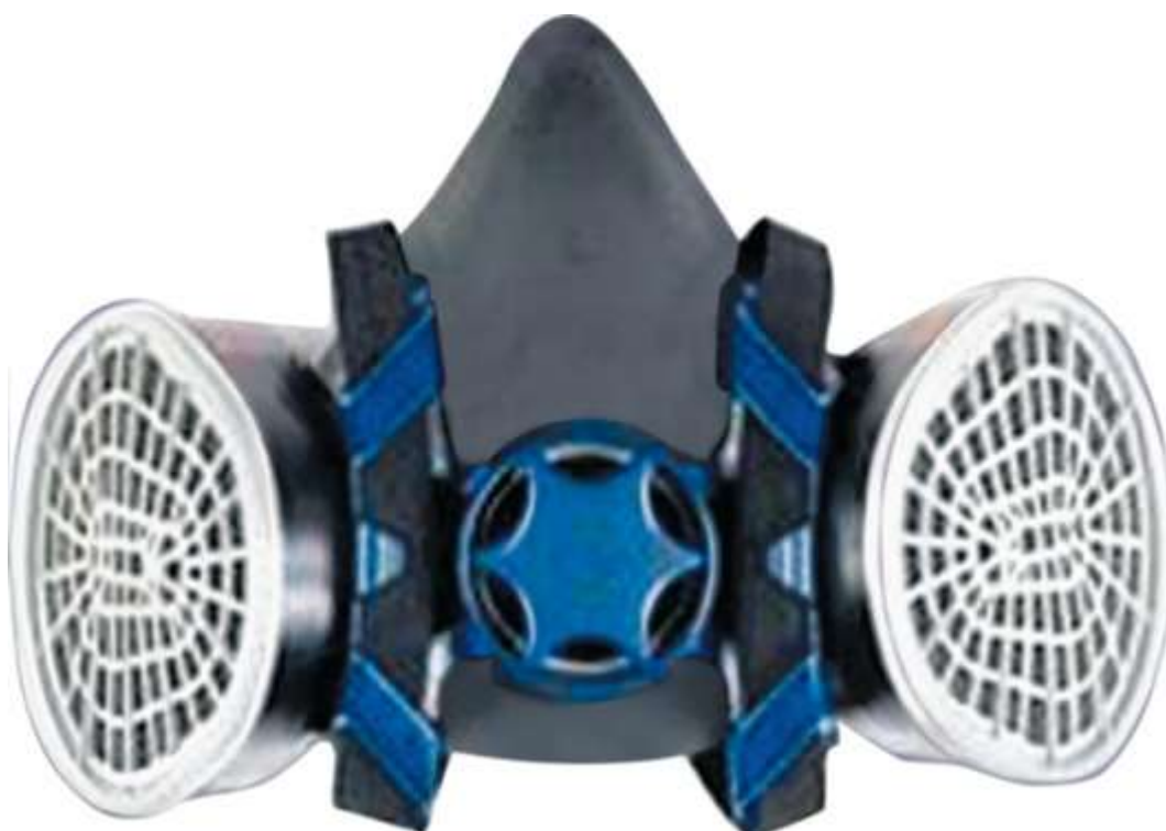
Рис. 25.3. Противоаэрозольный СИЗОД. Полумаска «Фернез 7000» многократного применения из термопластичного эластомера. Комплектуется двумя сменными фильтрами. Универсальный размер. Удобная система регулируемых ремешков. Область допустимого применения - до 10 ПДК рз
