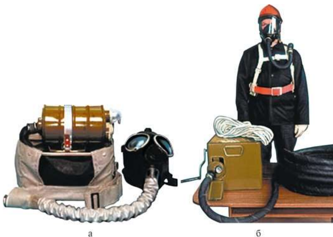
Рис. 25.2. Изолирующие СИЗОД: а - изолирующий противогаз «ИП-4М». Противогаз ИП-4М предназначен для защиты органов дыхания, глаз, кожи лица человека от воздействия вредных веществ, присутствующих в воздухе рабочей зоны, независимо от их состава и концентрации, а также в условиях недостатка или отсутствия кислорода. В комплект входят: лицевая часть (маска МИА-1 с переговорным устройством), мешок дыхательный с клапаном избыточного давления, каркас, пленки незапотевающие, манжеты утеплительные, сумка. Маска МИА-1 выпускается 3 ростов. Противогаз снаряжается регенеративными патронами одноразового действия РП-4-01. Время защитного действия противогаза при физической нагрузке - не менее 40 мин. Температурный интервал эксплуатации от -40...50\text{ }^{\circ}\text{C} ; б - противогаз шланговый изолирующий «ПШ-2». Противогаз шланговый ПШ-2 предназначен для защиты органов дыхания, глаз и лица человека от воздействия вредных веществ, присутствующих в воздухе рабочей зоны, независимо от состава и концентрации, а также при выполнении работ в условиях недостаточного содержания кислорода. Рекомендуется при выполнении работ в замкнутых емкостях, цистернах, колодцах и т.п. в различных отраслях промышленности и в коммунальном хозяйстве. Представляет собой низконапорный двухканальный изолирующий дыхательный аппарат, в котором воздух под лицевую часть подается по шлангу с помощью воздуходувки, расположенной в зоне чистого воздуха
