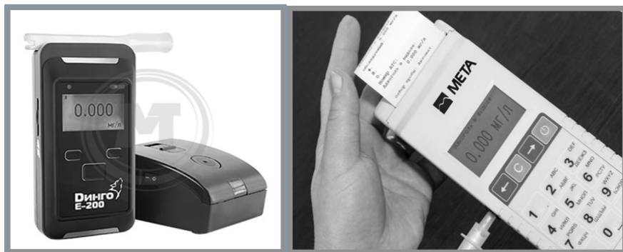
Рис. 4. Различные типы портативных алкотестеров, оснащенных принтером.
