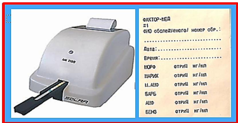
Рис. 6. Один из типов портативных иммунохимических анализаторов: слева – сам прибор с вставленной в него иммунохроматографической тест-полоской; справа – распечатка результата исследования мочи, выполненного этим анализатором.
