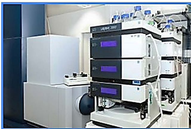
Рис. 14. Современный жидкостный тандемный хромато-масс-спектрометр (ВЭЖХ/МС/МС).
